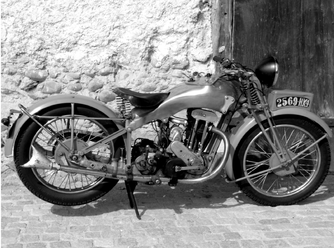
MGC van Marcel Guiget (1932) : zeer innovatief frame van gegoten aluminium. Dit ontwerp was zijn tijd ver vooruit.
